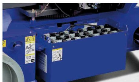
Batterie trazione di serie, garantiscono il 50% di vita in più rispetto alle batterie tradizionali con una riduzione dei tempi di ricarica del 40%
